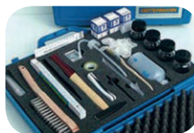
Diagnostický kufr – pro mobilní rozbor solí ve stavebních konstrukcích.
