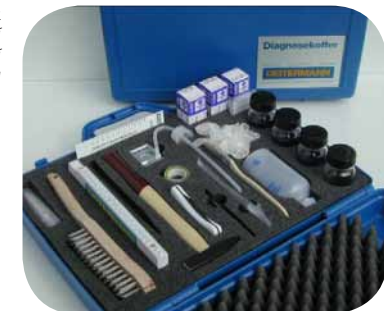
Mobilní souprava na zjišťování koncentrace solí ve zdivu a jejich analýzu
